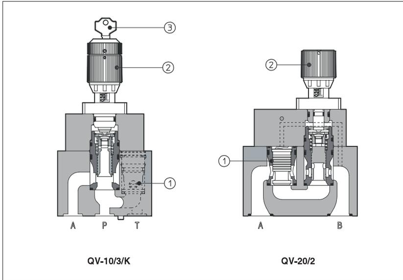
QV是带有压力补偿器①的流量控制阀，即流量与压力变化无关。此类阀适用于液压系统中。
