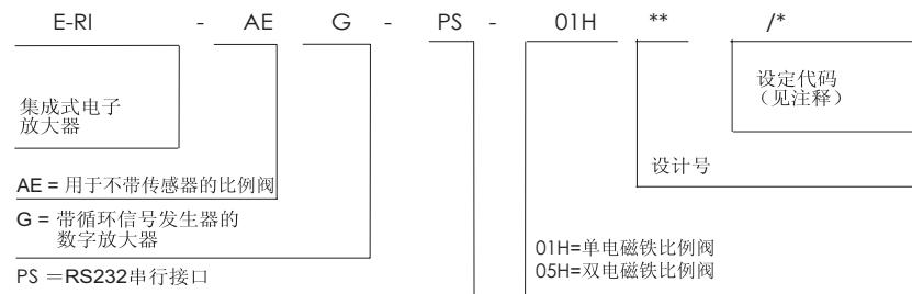
注释: 设定代码表明数字放大器与所配对的比例阀间的对应关系。当放大器作为备件单独订货时,由Atos出厂设定。
