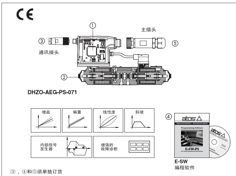
**1** 型号编码: 使用集成式放大器 E-RI-TES 的数字比例阀
