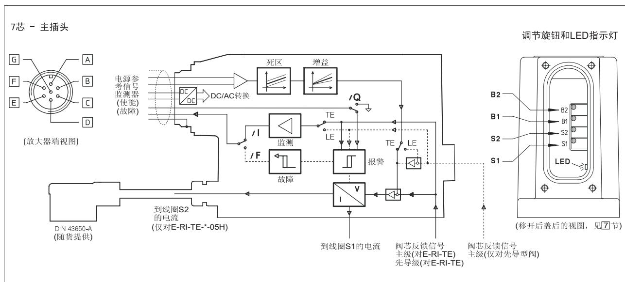
3 接线方框图 - 选项 /Z 和 /K(12 芯插头)
