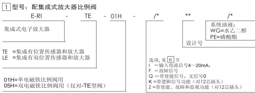
这类放大器①为集成式安装, 与Atos公司比例阀集成, 根据输入信号, 提供对直动式或先导式阀的滑/座阀芯的位置的闭环控制。
